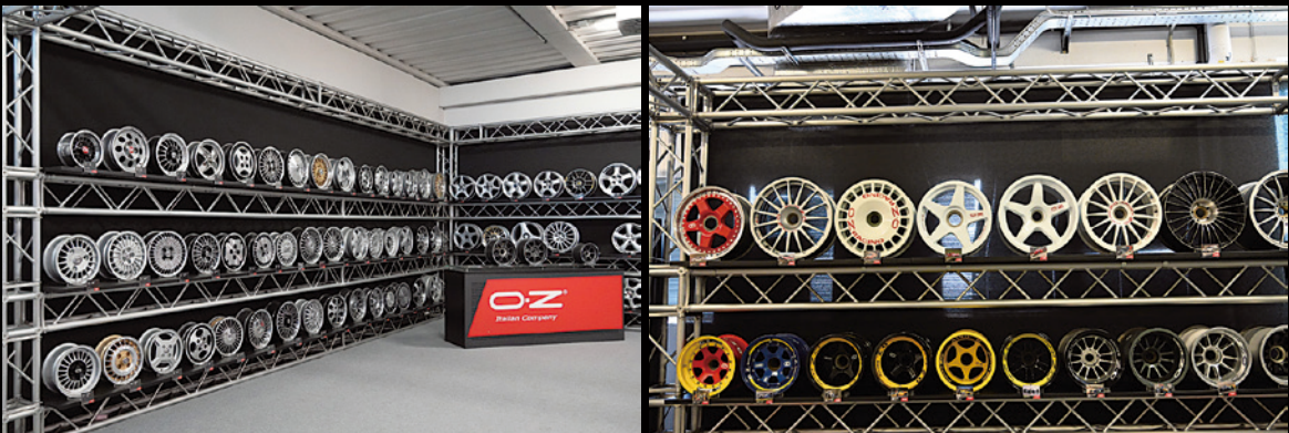
オーゼットの市販品の多くは、強度や剛性を保ちながら薄肉かつ複雑な形状を可能とする低圧鋳造法（ロープレッシャー製法）を採用する。さらにリム部を延伸成型するHLT（ハイ・ライト・テクノロジー）を組み合わせるモデルも多い。
