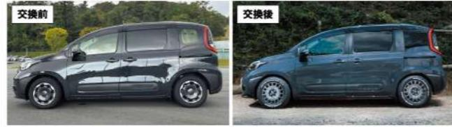
シエンタ純正は15インチで185/65サイズなので、今回1.5回りくらい外径がアップした195/65R16をセットアップ。タイヤハウスの隙間も少なくて、サイズ以上の大口径感を実現。このマッチングならステアリングを全間に切ってもギリギリインナーハンドル干渉もない。
