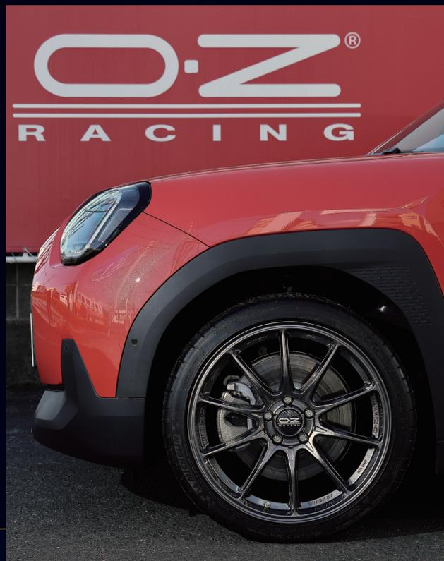
電気モーターで駆動するBEVは、ICE（内燃機関）での駆動とは違ってアクセルを踏んだ瞬間から最大トルクが発生する。さらに、大型の駆動用バッテリーを搭載していることから車重が重く、車両重量はエースマンSEでも1670kg、エースマンSEは1740kgもある。つまりはそのぶん、ホイールへの負担が大きい。
