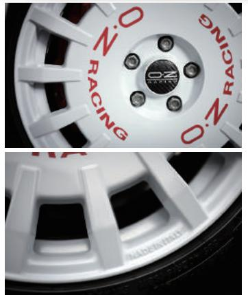
センターに広がるディスクデザインは、ターマックで跳ねた石がブレーキを破損させないようにガードするのが狙い。このディスクにフィン状のスポークを組み合わせたデザインが、OZレーシングのブランドイメージにもなっている。スポーク形状はハイパワー化とともにタイヤ性能の向上に合わせて刷新される。太く接地面も広げることで剛性と強度を格段にアップしているのだ。レーシングホワイトのカラーに赤いOZ Racingのロゴは多くのファンを虜にするブランドアイデンティティ。
