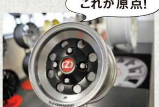
1971年、最初の合金リムが作られ、MINIクーパーに装着された記念すべきモデル
