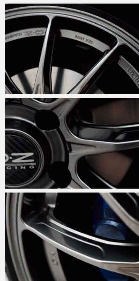
スポーク天面を極限まで薄く細く、逆に縦断面を厚く取って剛性を確保。縦断面形状やエアロウイングと呼ばれるリムエンドの形状、ローズマーキングというセンター付近の溝加工などは、最新のレーシングホイールからの技術である。
