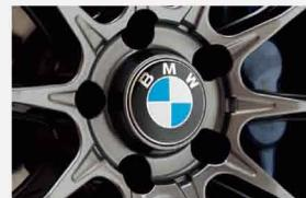
純正センターキャップを組み合わせることも可能だ。センター付近を円形状に設定して、5ホールのほか4ホールにも対応させている。
